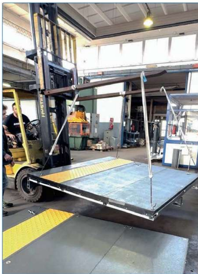
Fig. 1 - Test del sistema di installazione in fabbrica
