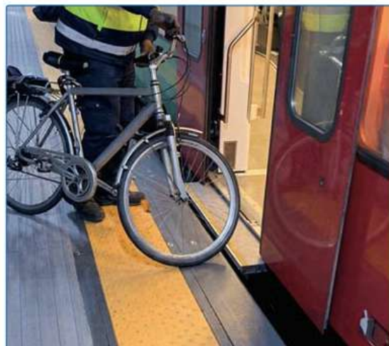
Fig. 5 - Particolare dell'allineamento fra treno e banchina
